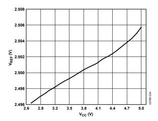
Figure 17. Internal V<sub>REF</sub> vs. V<sub>CC</sub>
